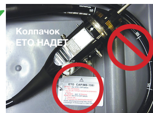
Эндоскоп, погруженный в жидкость, во время проверки на герметичность или обработки
