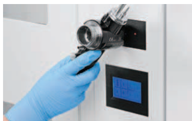
Автоматическое определение пользователя и эндоскопа с помощью RFID
